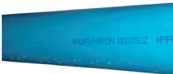
Estado de tubería NIRON con condensación superficial.
