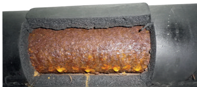
Estado tubería de acero aislada con corrosión por condensación.
