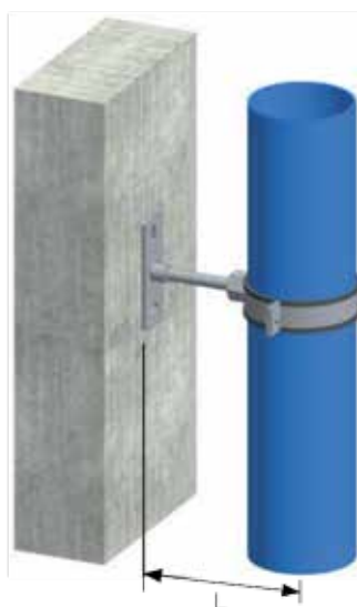
Ilustración 6 – Distancia entre el eje de la tubería y la pared en instalaciones vistas en posición vertical
